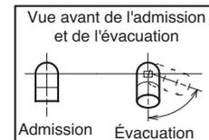
1 - La terminaison d'évacuation en T doit être connectée au conduit d'évacuation en PVC de 2 po ou 3 po comme indiqué sur l'illustration. Sur les applications à T horizontal, il doit y avoir un minimum de 3 pi des patios couverts ou de toute zone habitée et ne peut pas être à moins de 3 pi d'une fenêtre. Ne pas utiliser d'accélérateur dans les applications qui incluent une terminaison d'évacuation en T. L'accélérateur n'est pas obligatoire.
